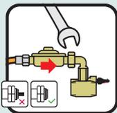
Sie sind im Besitz eines schweizer Druckreglers der an den Schlauch angeschlossen ist. Schrauben Sie den Druckregler an den Clip (mit Schlüssel festziehen). Vor dem Anschliessen alle Gasventile schliessen.
